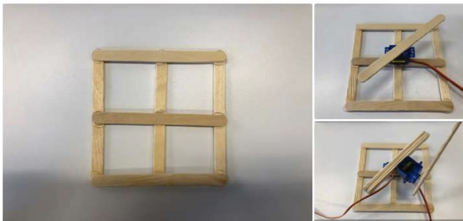
Gambar 2: Merancang model robot dan mengkombinasikan dengan penggerak motor servo [12]
